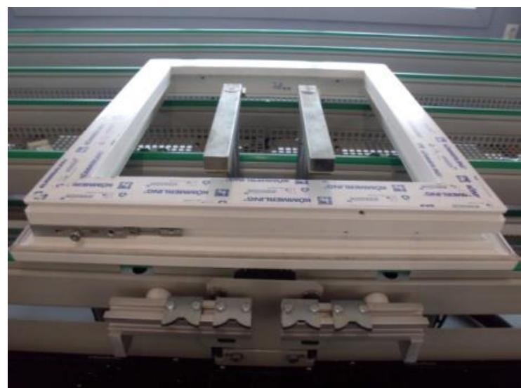
17. Pour placer la tête de compas, il faut au préalable serrer et centrer le châssis avec le bouton-poussoir bleu. Appuyer sur le bouton-poussoir bleu (4) tout en gardant le châssis contre les butées et attendre que celui-ci soit centré et pressé. Pendant cette étape, les voyants des boutons pousoirs de la commande bi manuelle (6 et 7) restent allumés.
