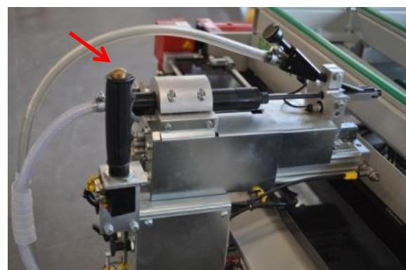
On utilisera une crémone OB à poignée variable. Il faut la recouper pour quelle s'adapte à la dimension du châssis. Afin de réaliser le travail dans les normes, on aura soin de laisser le châssis serré et centré sur la table à quincaillerie. Celle-ci est munie d'une butée constante et d'un support avec repère qui se règle automatiquement suivant la dimension du châssis.
