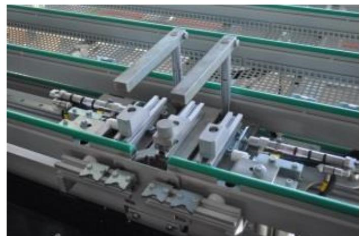
3. Positionner l'ouvrant sur la table de telle sorte que celui-ci soit bien contre les butées. Attention que le positionnement de l'ouvrant se fait toujours sans les lattes à vitrage.
