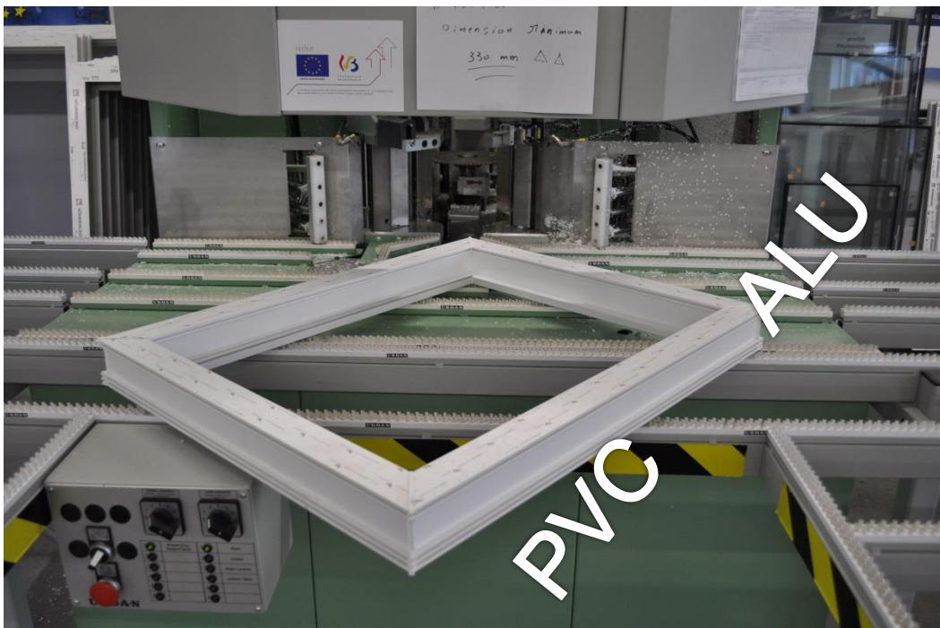
9. Suivant le type de profilé (marque, couleur) régler la console secondaire correctement.
