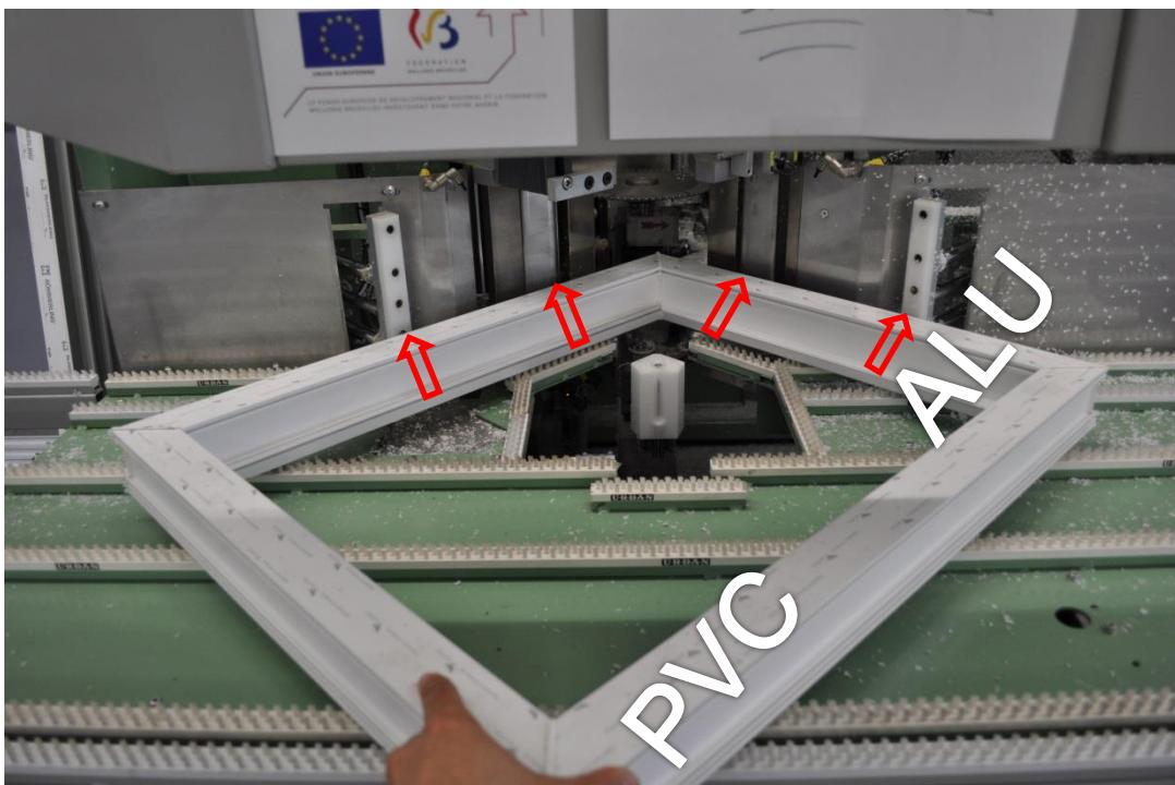
11. Le guide automatique positionne le cadre correctement et les vérins serrent le cadre.
