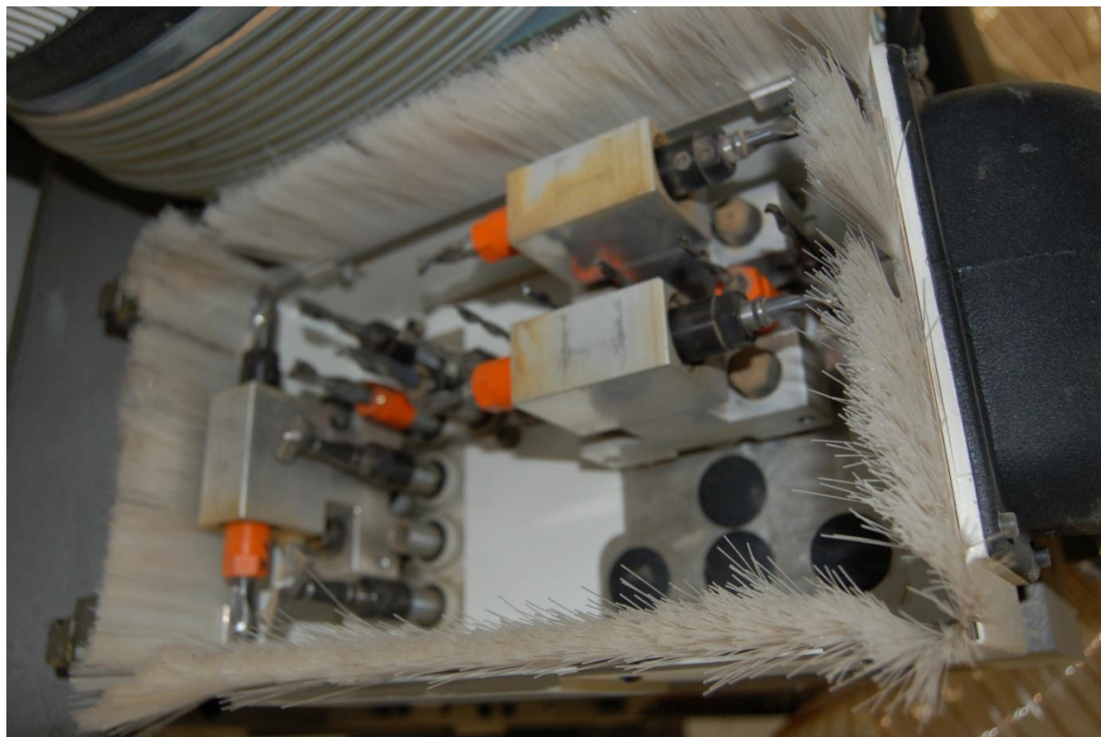
Tête de forage sur 3 axes
