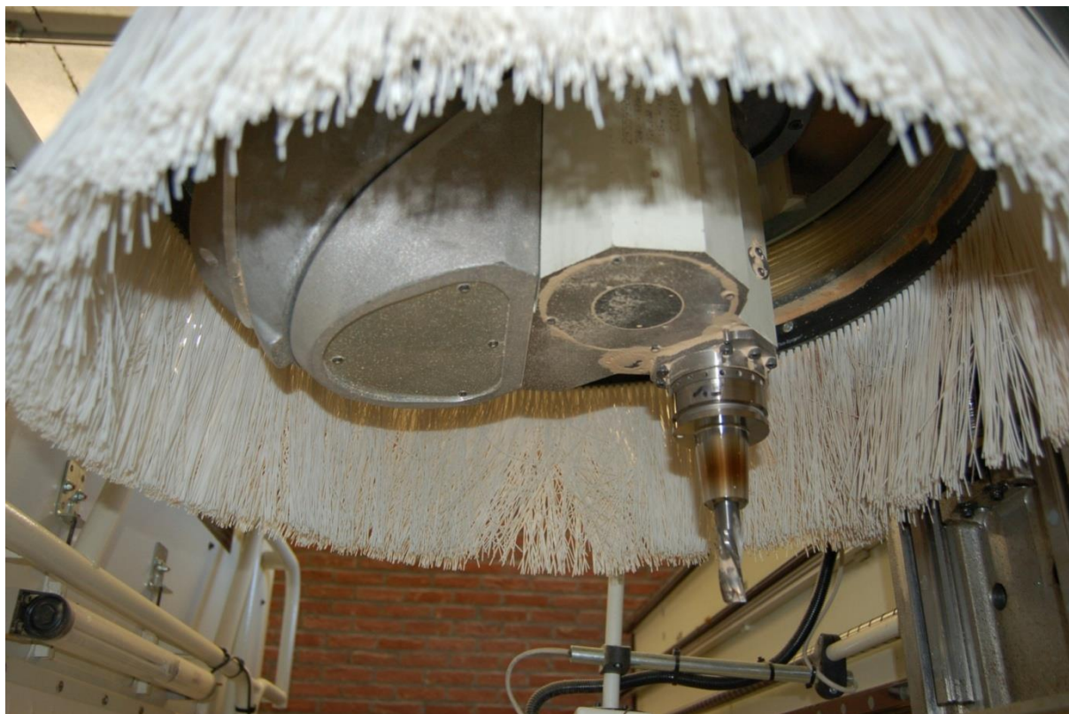
Tête mobile sur les 5 axes
